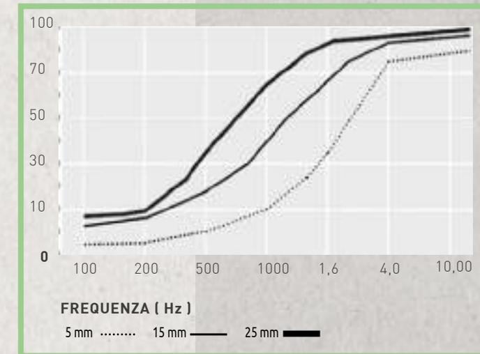
L'Akustik® - Firex il poliuretano espanso flessibile a celle aperte, sottoposto ad un trattamento di impregnazione che gli conferisce eccellenti caratteristiche acustiche e di reazione al fuoco. L'Akustik® - Firex, con una densità di 90 Kg/m<sup>3</sup>, risulta essere un ottimo materiale assorbente e, data la massa, anche fonoimpedente.
