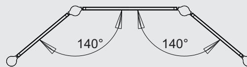
Il sistema modulare può essere ruotato fino a 140°.
