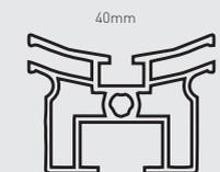
Cornice completa con profili in alluminio anodizzato color argento, angoli in metallo pressofuso color argento opaco. Nella cornice è incluso anche il kit per il fissaggio a soffitto
