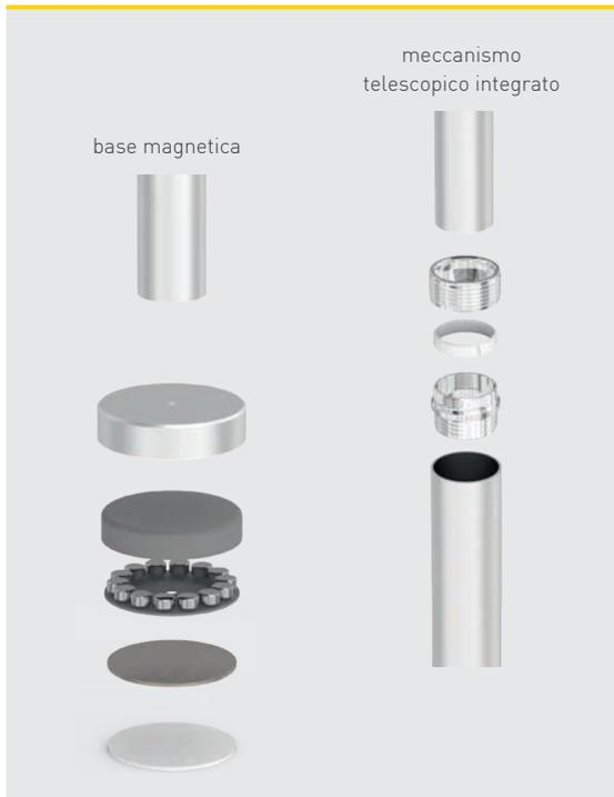
A sinistra, la base con calamita WKP N35 - Ø 52x10,5mm - con foro per vite M6x10mm. A destra, i componenti del meccanismo telescopico.
