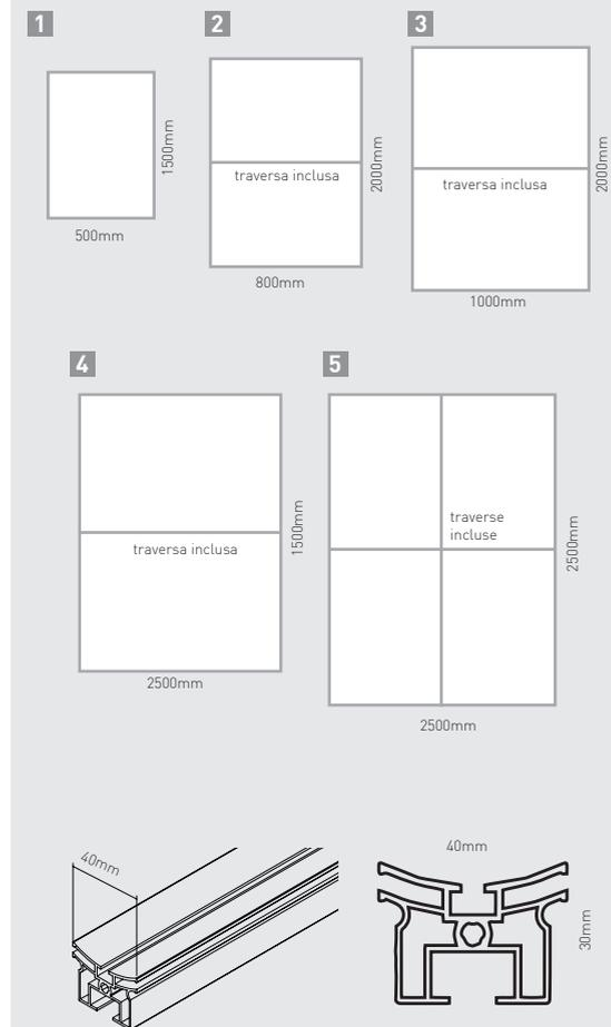
Cornice completa con profili in alluminio anodizzato color argento, angoli in metallo pressofuso color argento opaco.
