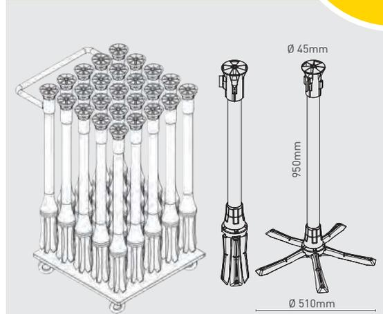
Per trasportare quantità più importanti di Tempaline, c'è anche il pratico carrello che può contenere un massimo di 25 colonnine. Altezza colonnina: 950 mm. Diametro testa: 45 mm. Diametro base: 510 mm
