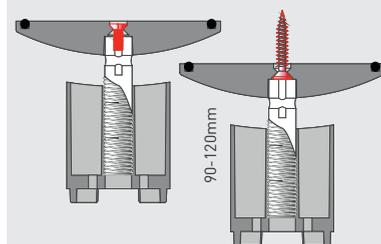
Nel disegno, dettaglio di funzionamento dell'applicazione a soffitto e a pavimento
